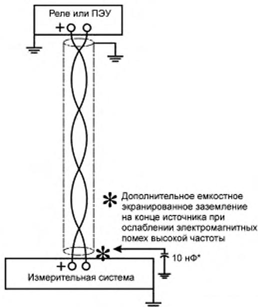
Рисунок 2 — Одна измерительная система и один вход реле
