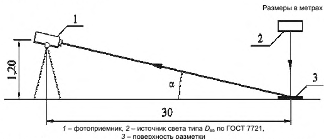
Рисунок 12 – Условия определения удельного коэффициента светоотражения при диффузном дневном или искусственном освещении
