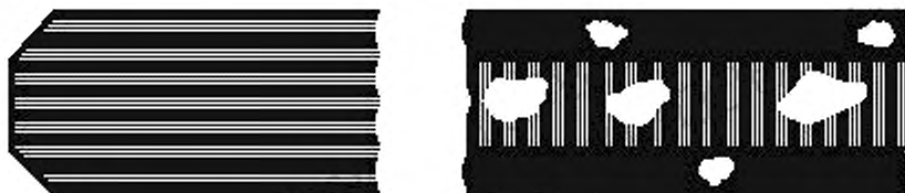
Рисунок А.2 — Грубошлифованная кромка
