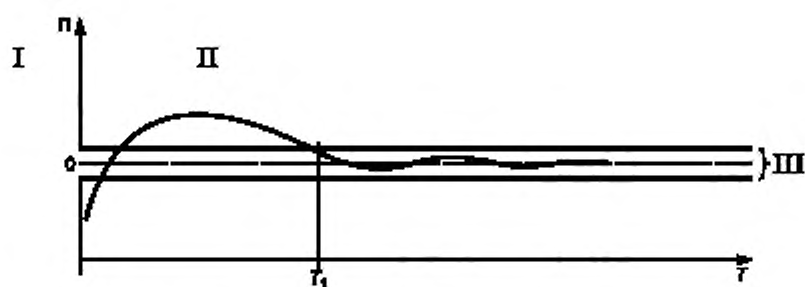
I — питание включено; II — питание включено; III — пределы допускаемых отклонений показаний прибора в чистом воздухе; П — показание; T — время; 0 — ноль прибора; T_1 — время прогрева (см. 2.6.7)
