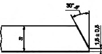
а) при номинальной толщине стенки ( $S_{ном}$ ) до 16,0 мм включительно
