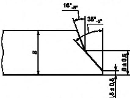
б) при номинальной толщине стенки ( $S_{ном}$ ) более 16,0 мм
