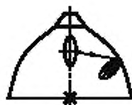
б — отражатель с направленно-рассеянным или смешанным отражением, выходное отверстие открыто или с прозрачным рассеивателем
