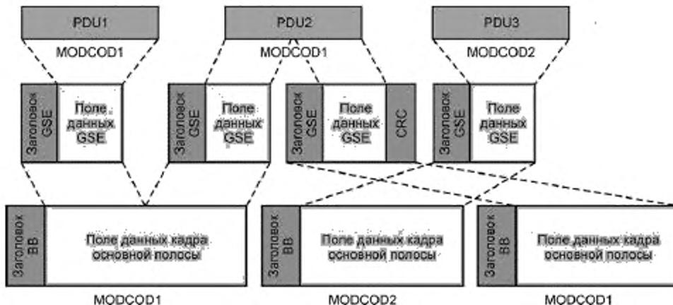
Рисунок А.3 — Совмещенные операции инкапсуляции и планирования
