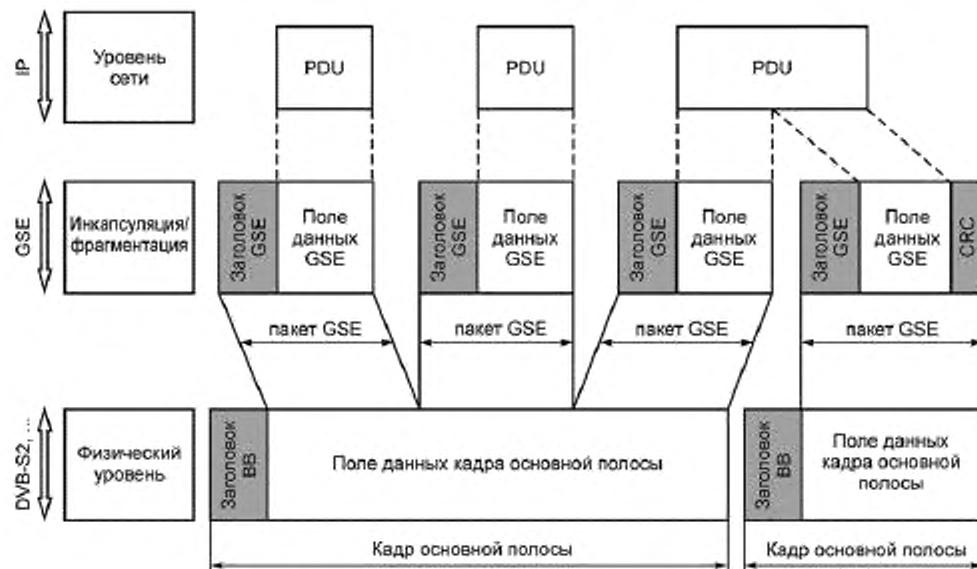
Рисунок 1 — Схема инкапсуляции GS со стеком протоколов DVB
