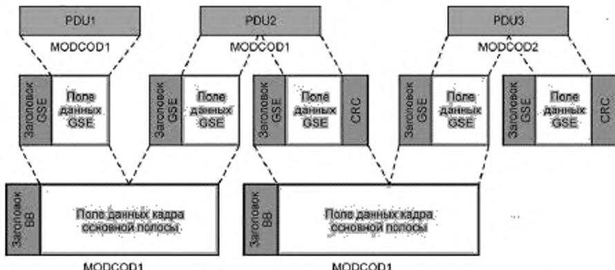
Рисунок А.2 — Несимволические операции инкапсуляции и планирования
