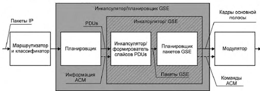
Рисунок А.1 — Блок-схема инкапсулятора и планировщика
