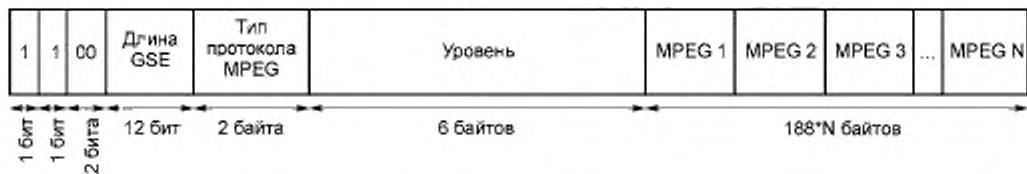
Рисунок В.5 — Пакеты сигнализации MPEG инкапсуляции GSE
