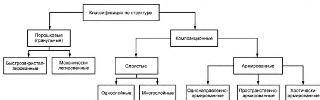
Рисунок 1 — Классификация порошковых материалов по структуре
