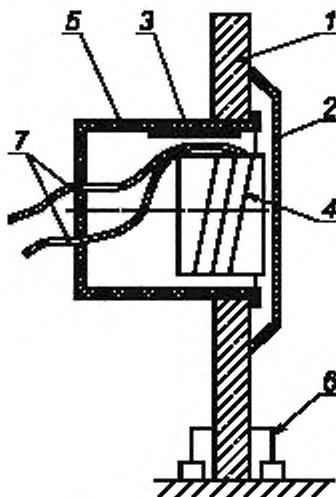
1 — держатель камеры из негорючего материала; 2 — передняя стенка камеры; 3 — устройство пожаротушения; 4 — никромо-вава спираль и МОП; 5 — огневая камера; 6 — крепление; 7 — соединительные провода
