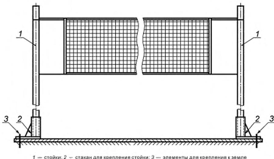
Рисунок 2 — Элементы конструкции волейбольного оборудования типа 2
