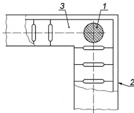
1 — место испытания; 2 — натяжная рама; 3 — защитная крышка рамы и натяжной части
