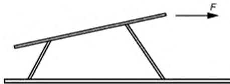
Рисунок Б.1 — Схема приложения сосредоточенной горизонтальной нагрузке при оценке устойчивости и скольжения батута
