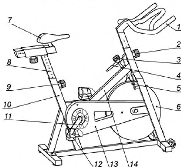
1 — руль; 2 — регулятор поручня; 3 — регулятор напряжения; 4 — аварийный тормоз; 5 — система сопротивления (тормоз); 6 — маховик; 7 — сиденье; 8 — стойка сиденья; 9 — регулятор высоты сиденья; 10 — подседельная труба рамы; 11 — шатун педали; 12 — педаль; 13 — защита трансмиссии; 14 — рама
