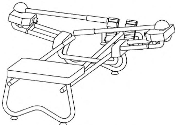
Рисунок 1 — Тренажер для гребли с системой парных весел
