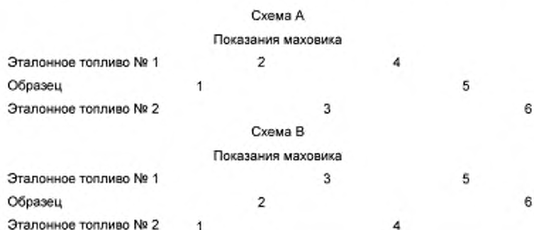
Рисунок 3 — Последовательность снятия показаний для образца и эталонных топлив
