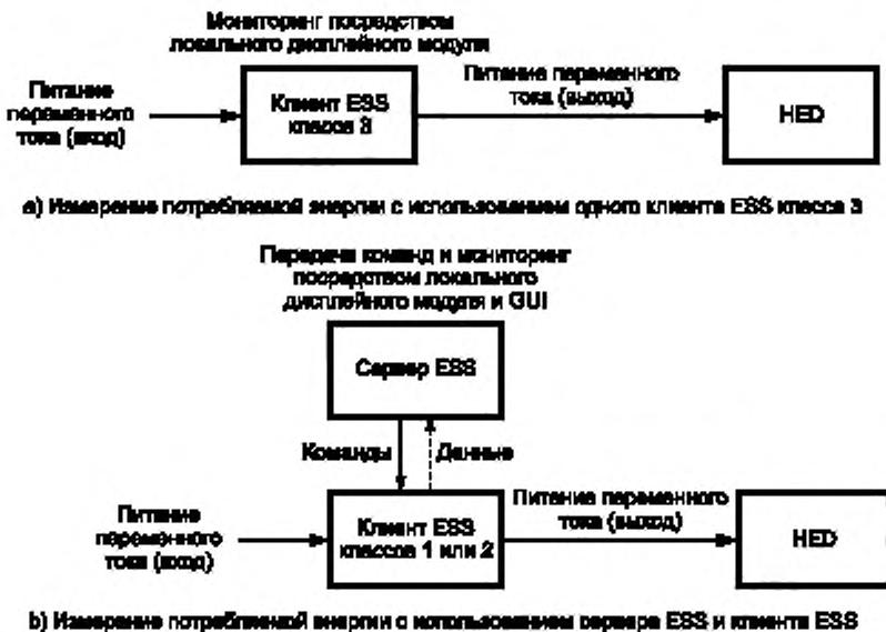
Рисунок 4 — Пример несетевого измерительного устройства
