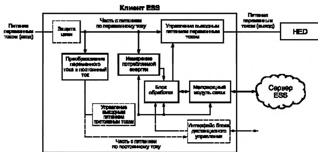
Рисунок 3 — Базовая архитектура клиента ESS
