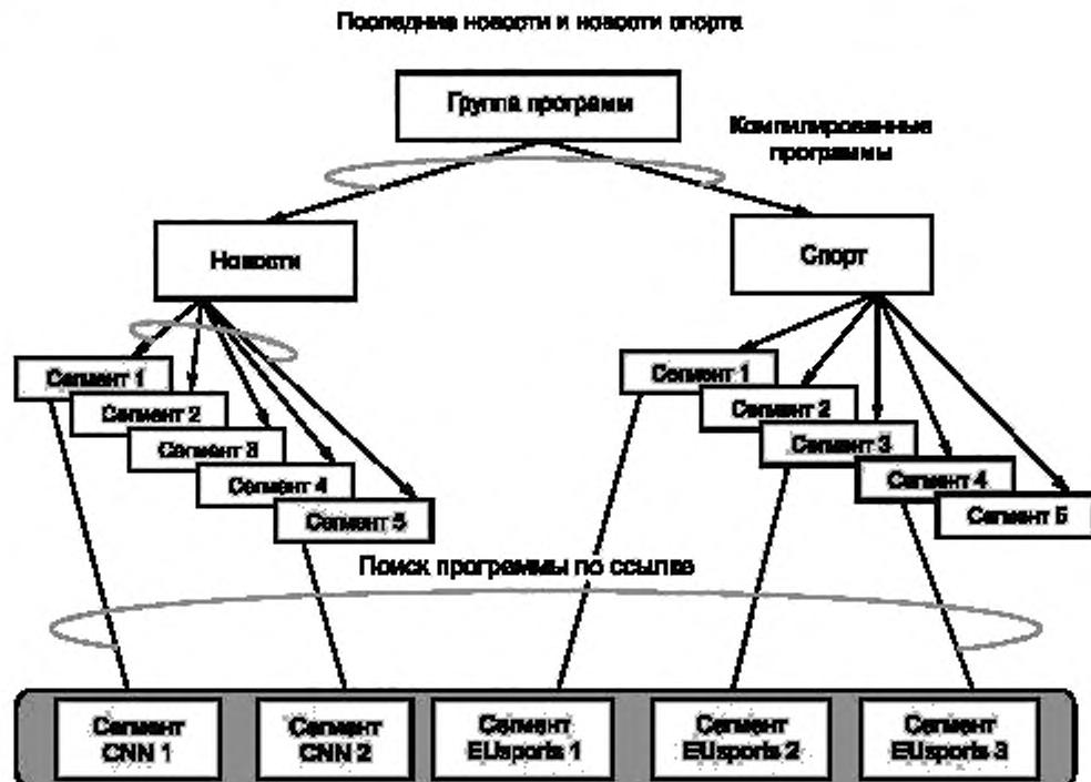
Рисунок 13 – Компиляция обновленных сегментов от нескольких провайдеров
