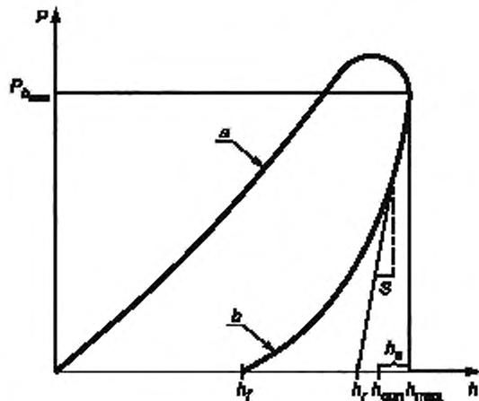
а — этап нагружения (контактное усилие растет); б — этап разгрузки (уменьшения контактного усилия)
