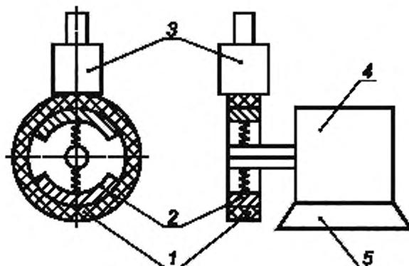
1 — контролируемое изделие; 2 — фиксирующие кулачки; 3 — ударный преобразователь, 4 — механизм позиционирования,
