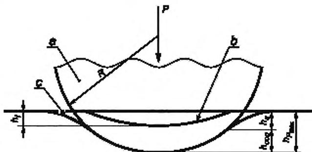
а — индентор; б — поверхность пластического отпечатка в лунке после снятия нагрузки;
