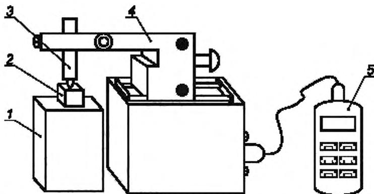
1 — массивное основание; 2 — объект контроля; 3 — ударный преобразователь, 4 — система позиционирования,
