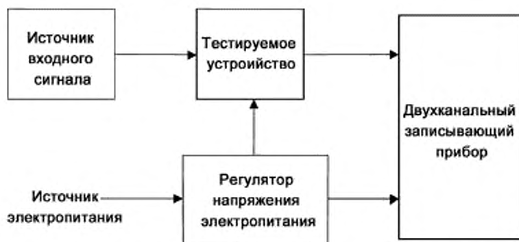
Рисунок 1 – Схема проведения испытаний для определения влияния понижения напряжения электропитания или его кратковременного отключения
