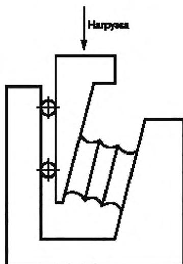
Рисунок 2 — Установка рессоры на стенде
