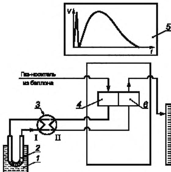
1 — стакан вместимостью 250 см<sup>3</sup> по ГОСТ 25336; 2 — U-образная стеклянная трубка с внешним диаметром 5 мм, высотой 100 мм, расстоянием между концами 35 мм; 3 — четырехходовой кран; 4 — сравнительная ячейка детектора; 5 — самописец; 6 — измерительная ячейка детектора
