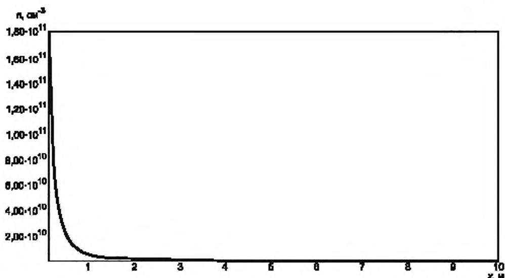
Рисунок 5.7 — Распределение концентрации плазмы  $n, \text{см}^{-3}$ , в струе двигателя СПД-70 вдоль оси струи
