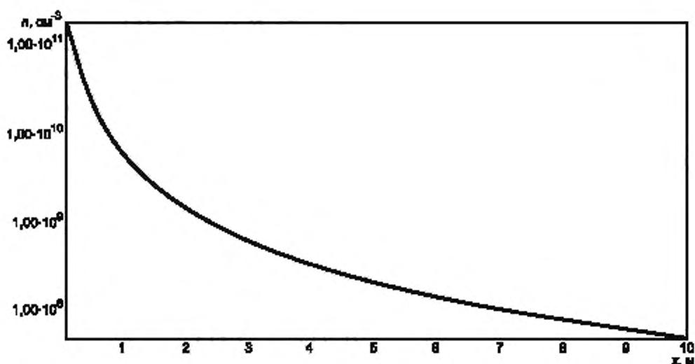
Рисунок 5.8 — Распределение концентрации плазмы  $n, \text{см}^{-3}$ , в струе двигателя СПД-70 вдоль оси струи (логарифмическая шкала)
