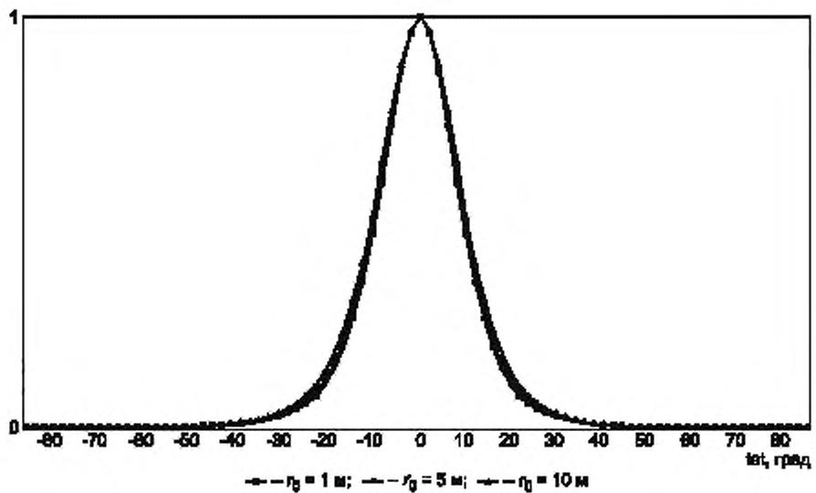
Рисунок Б.3 — Распределение концентрации плазмы  $n/n_c$  поперек струи для двигателя СПД-100
