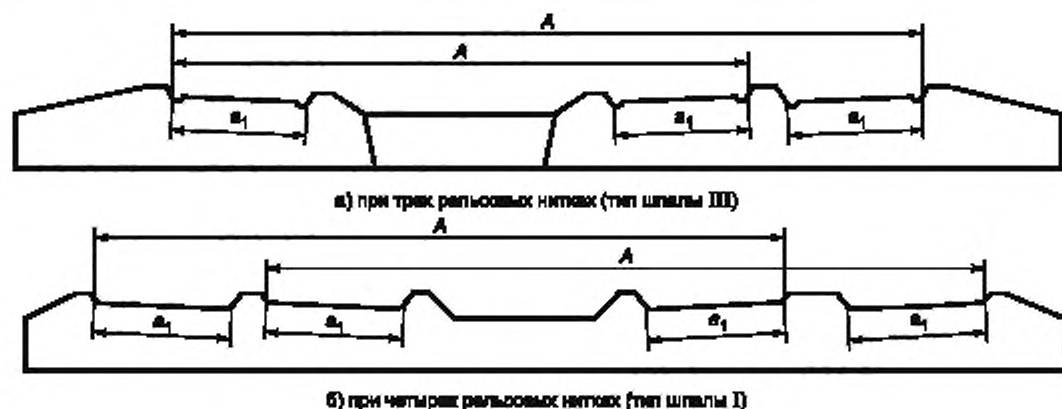
Рисунок 4 — Схема шпал с совмещенной колеей разной ширины
