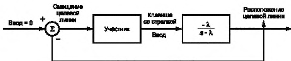
\lambda — уровень неустойчивости или интенсивность расхождения (настраиваемый); s — переменная преобразования Лалласа Рисунок 1 — Блок-схема системы управления
