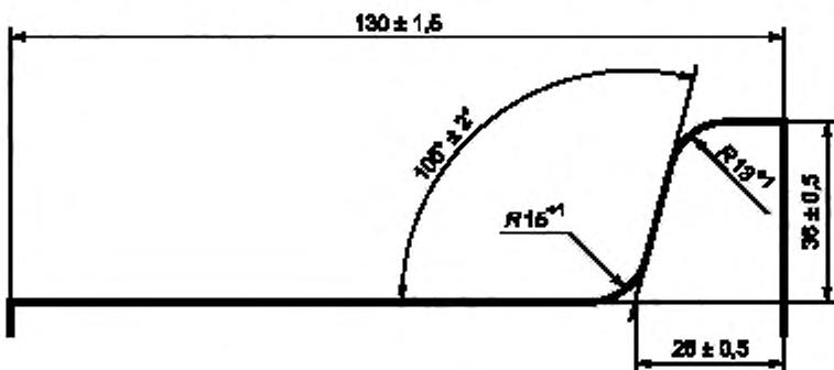
Рисунок 2 — Геометрические размеры профиля обода колеса
