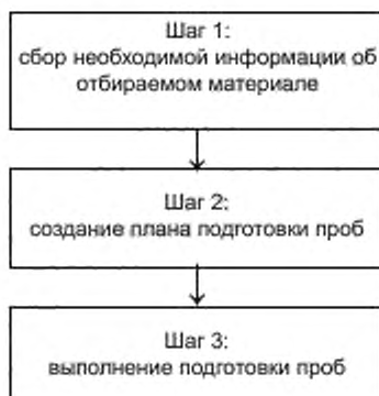
Рисунок 6 — Общая процедура подготовки проб
