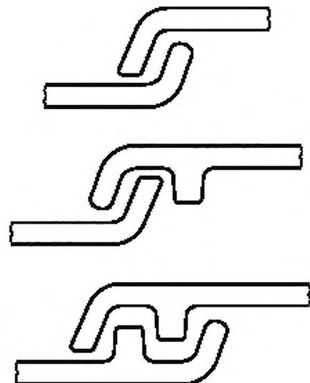
Рисунок 1 — Примеры пазовых конструкций
