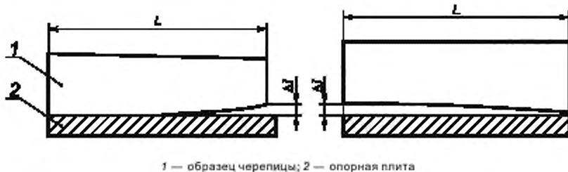
Рисунок 2 — Пример определения прямолинейности ребер черепицы
