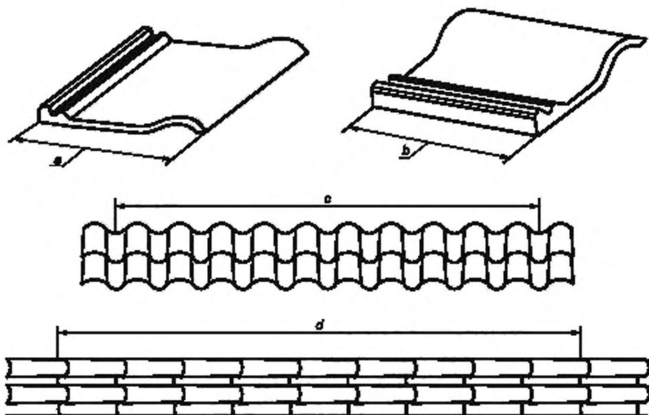
а — габаритная длина; б — габаритная ширина; с — кроющая (полезная) длина; д — кроющая (полезная) ширина
