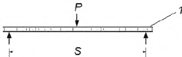
Рисунок 2 — Схема приложения нагрузки при трехточечном изгибе
