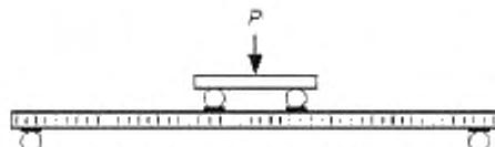
Рисунок 1 — Испытываемый образец и приспособление для проведения испытания
