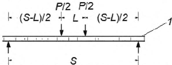
1 — образец;  $P$  — нагрузка;  $S$  — длина пролета;  $L$  — длина нагружаемого пролета
