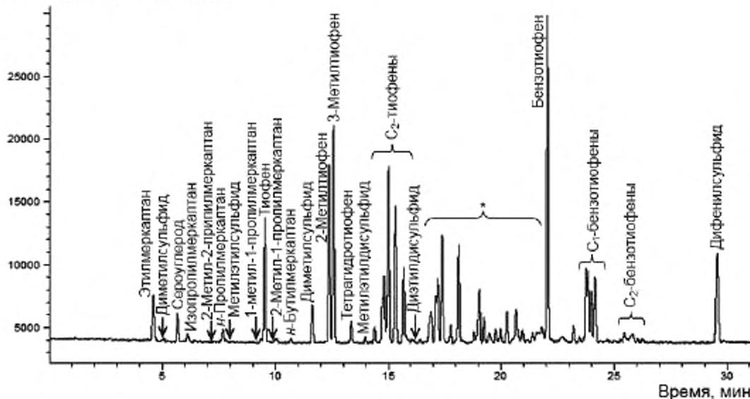
Рисунок 4 – Типовая хроматограмма пробы дистиллята с использованием капиллярной колонки Optima-5
