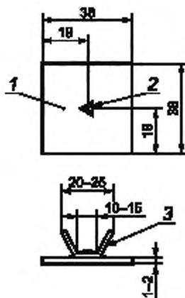
1 — пластинка; 2 — трехгранный керн (глубина керна 0,5—0,7 мм, угол наклона между плоской гранью и осью керна  $60^\circ$ );
