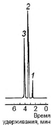
Рисунок 3 — Типовая хроматограмма сернистых соединений в нефти на колонке с 2 % ТБЦЭП на диатомитовом кирпиче
