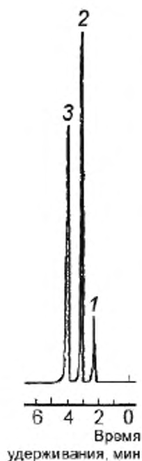
Рисунок 2 — Типовая хроматограмма сернистых соединений в нефти на колонке с 2 % ОДПН на диатомитовом кирпиче
