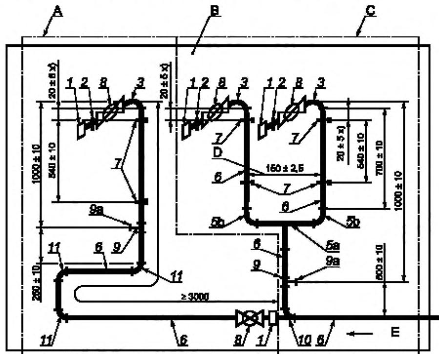
А — устройство соединения для контроля ОУШ; Б — стена для монтажа двойникового выхода; С — двойниковый выход; Д — расстояние между средними линиями трубопровода; Е — от испытательной стены, х) расстояние между кронштейном и коленчатым патрубком G4
