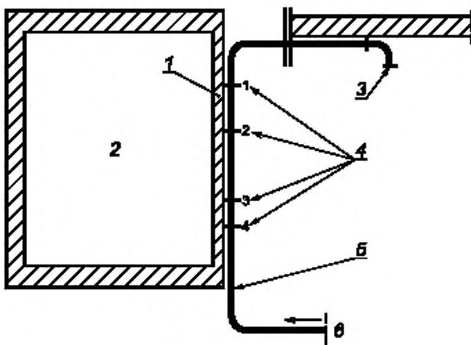
1 — испытательная стена, 2 — испытательное помещение, 3 — места присоединения устройства, 4 — места крепления испытательного трубопровода; 5 — испытательный трубопровод, 6 — от системы водоснабжения
