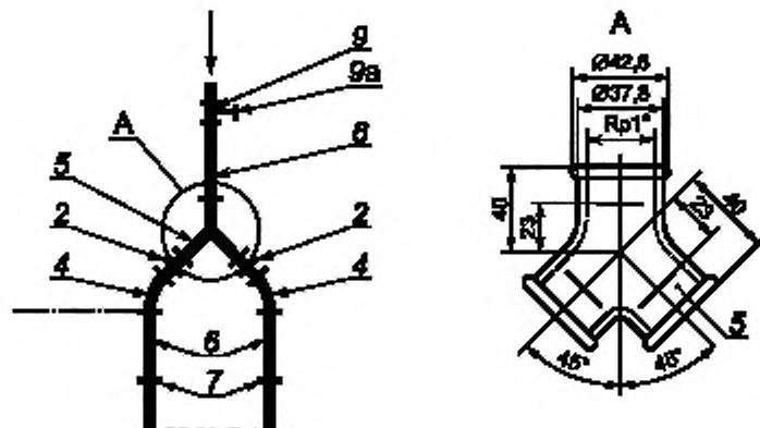
Оцинкованные соединения согласно [2]:
