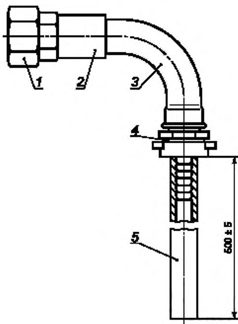
1 — оцинкованная соединительная муфта с конусным гнездом типа U11-1 [2]; 2 — собранное в соответствии с рисунком 5 ОУШ; 3 — оцинкованный коленчатый патрубок G4-¾ [2] с двусторонней внутренней и односторонней наружной резьбой; 4 — соединительная муфта R ¾, с резьбой по [3], с латунной хвостовой частью для гибкого рукава внутренним диаметром 13 мм; 5 — гибкий рукав внутренним диаметром  $(13 \pm 0,5)$  мм и толщиной стенки  $(3 \pm 0,3)$  мм
