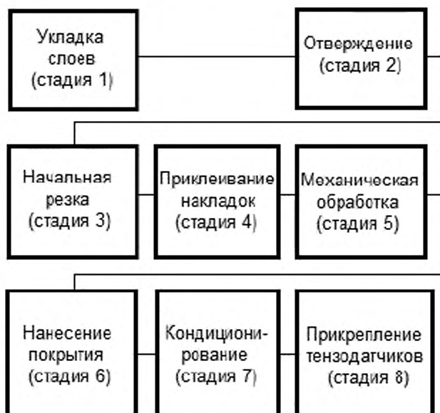
Рисунок 1 — Процесс изготовления образцов для испытания
