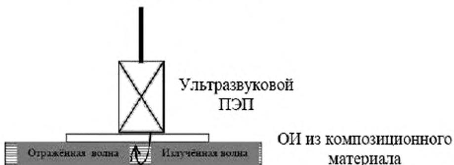
Рисунок 2 — Метод А. Ручной ультразвуковой эхо-импульсный метод
