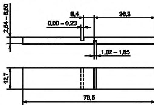
Рисунок 2 — Эскиз образца
