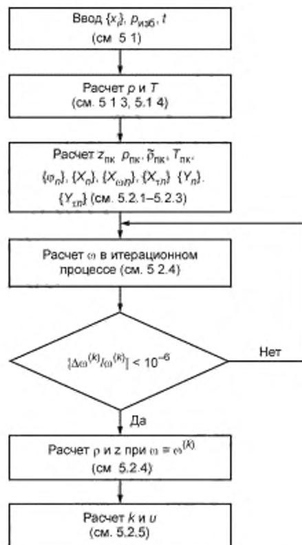
Рисунок 1 – Блок-схема расчета термодинамических свойств СПГ
