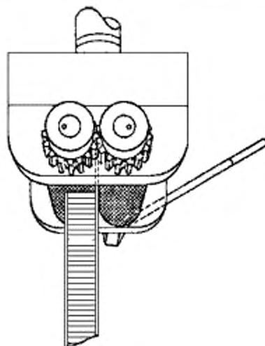
Рисунок 2 — Схема фиксации трехслойного образца в верхнем захвате
