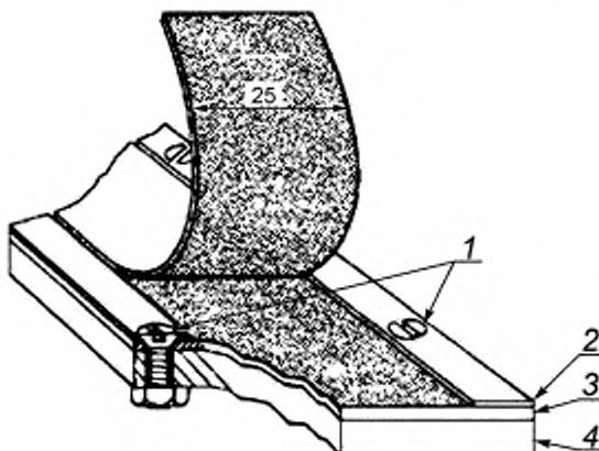
1 — зажимные винты; 2 — алюминиевая панель 0,5 мм; 3 — алюминиевая панель 1,6 мм;
