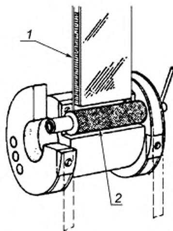
1 — трехслойный образец; 2 — эксцентрик барабана
