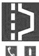
Рисунок Б.4 — Площадка для аварийной остановки
