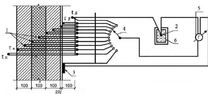
Сечение стены и подключение датчиков
