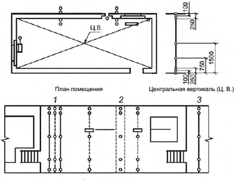
1 — наружный угол; 2 — стык наружных панелей; 3 — стык наружной и внутренней панелей
