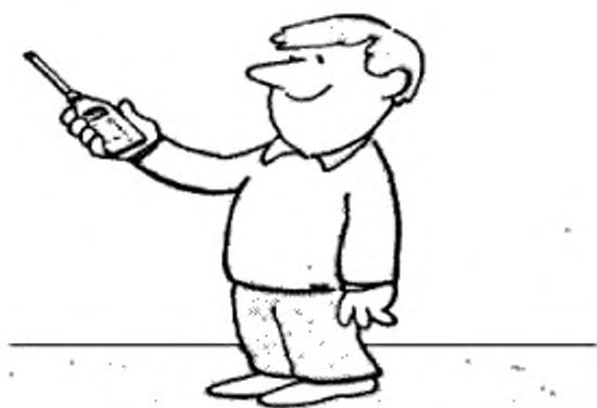
Рисунок 2 — Пример перемещения шумомера во время измерений
