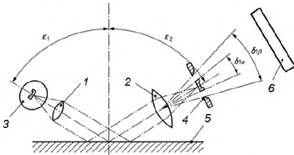
1 — коллимирующая линза; 2 — объектив коллектора, диафрагма которого расположена под углом  $\pi/2 + \varepsilon_1$ ;
