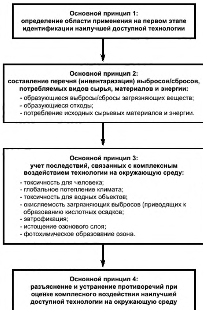
Рисунок 2 — Основные принципы методологии определения НДТ с учетом оценки аспектов ее комплексного воздействия на окружающую среду
