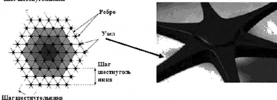
Рисунок 1 — Схематическое изображение георешетки и ее узел
