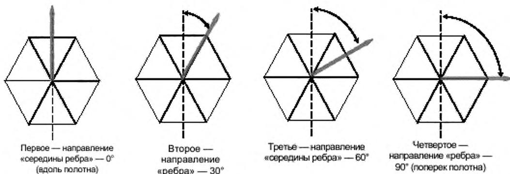
Рисунок А.1 — Четыре направления тестирования георешетки
