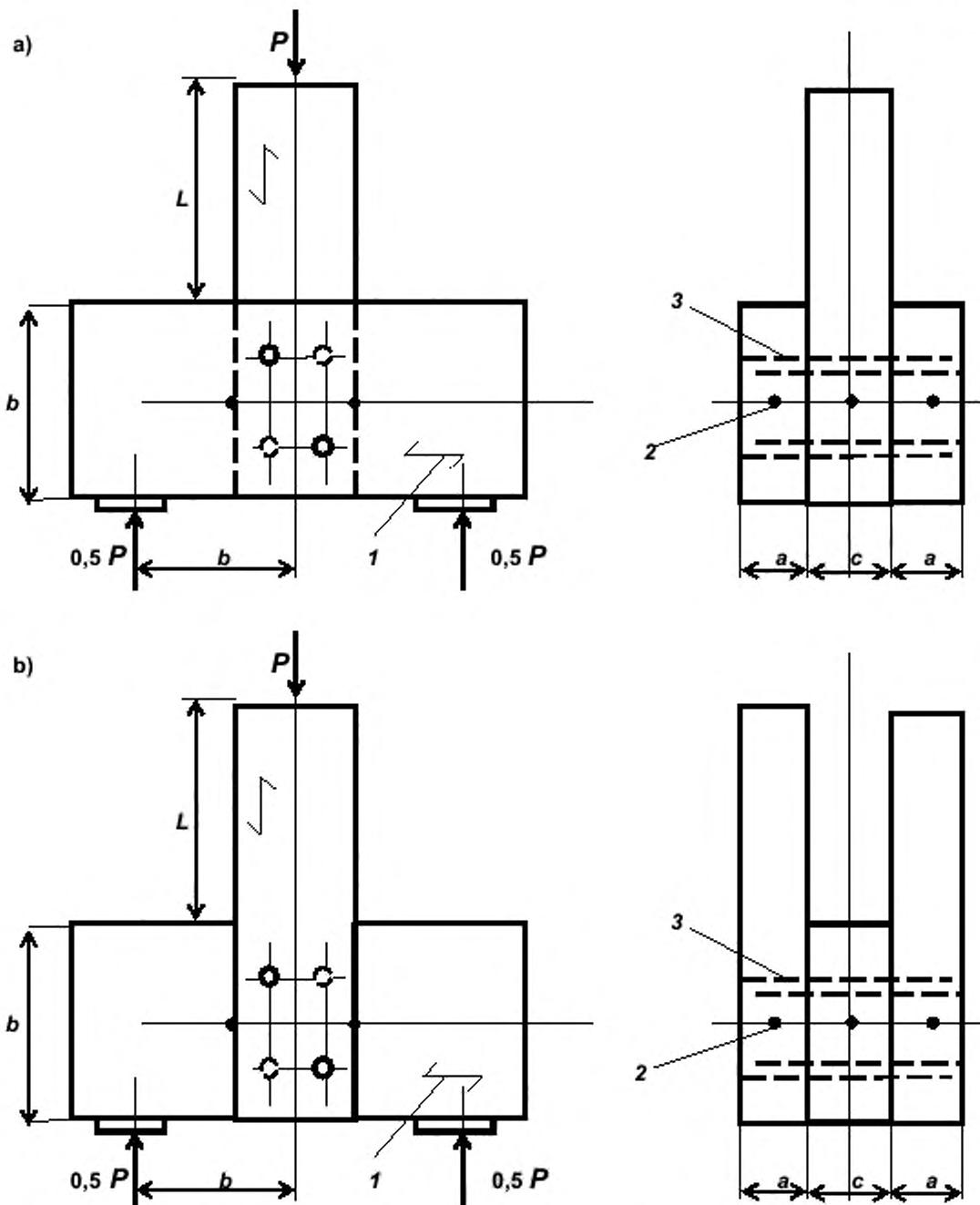
Рисунок 6 — Образец для испытания двухрезных соединений при смятии поперек волокон древесины
