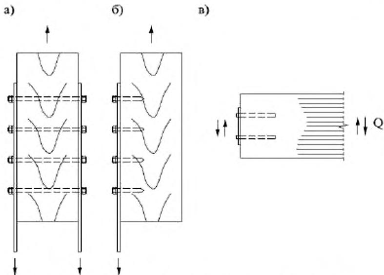
а — на болтах и шпильках; б — на глухих цилиндрических нагелях;
