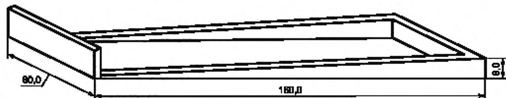
Рисунок А.1 — Форма для изготовления образцов при определении стойкости к образованию трещин
