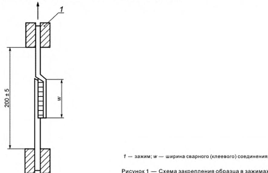
Рисунок 1 — Схема закрепления образца в зажимах
