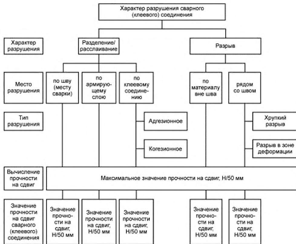
Рисунок А.1 — Характер разрушения сварного (клеевого) соединения
