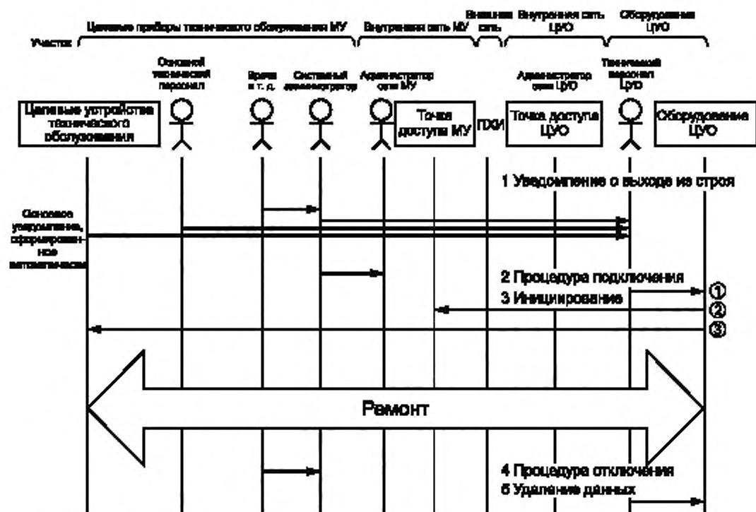
Рисунок 2 — Порядок работы в случае устранения неисправностей
