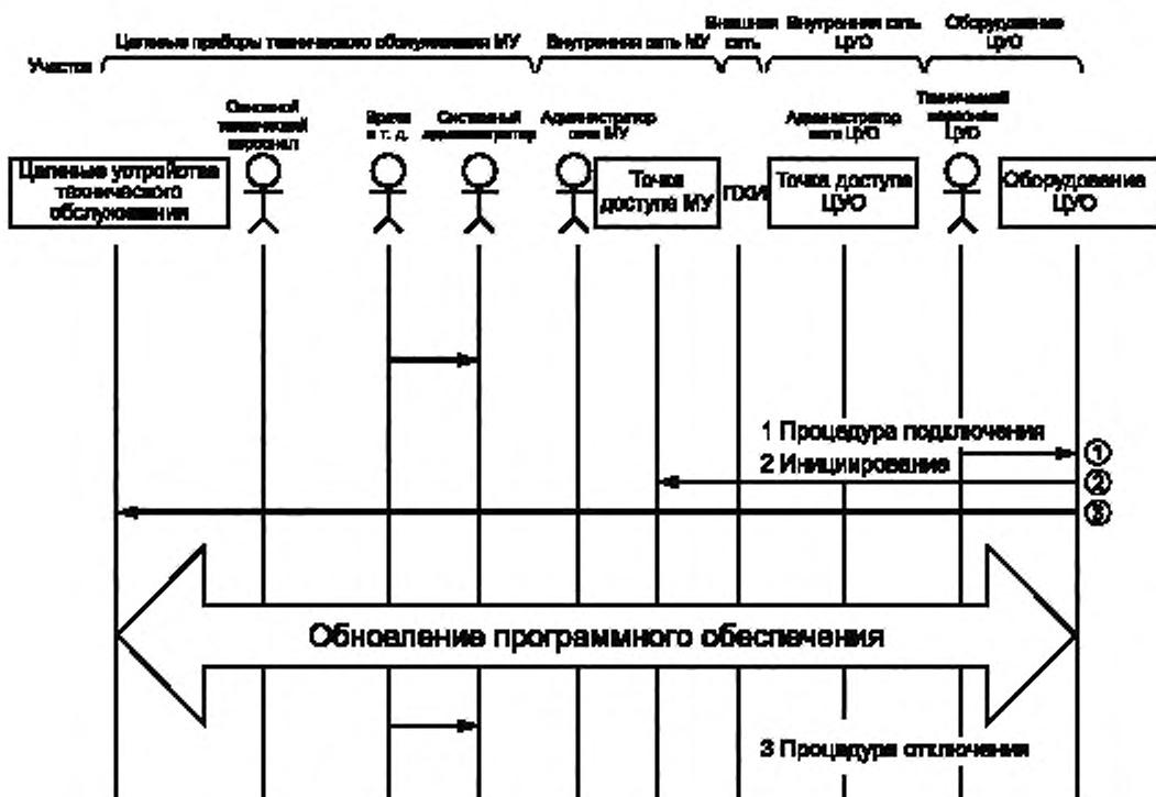
Рисунок 4 — Порядок работы в случае обновления программного обеспечения
