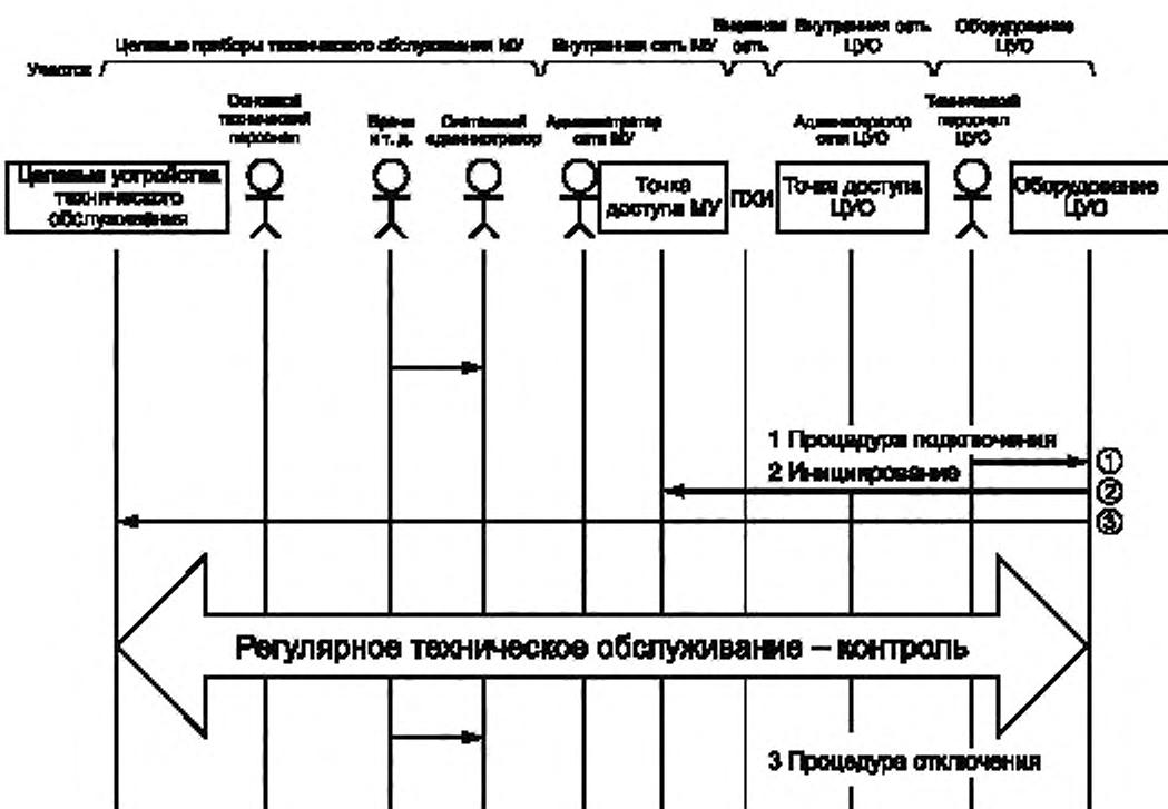
Рисунок 3 — Порядок работы в случае регулярного технического обслуживания
