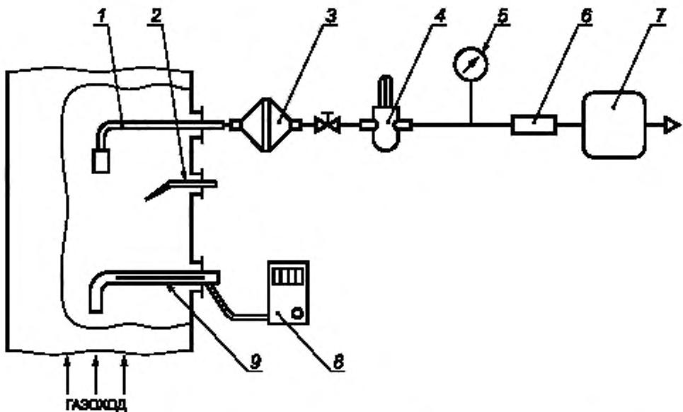
1 — пылезаборная трубка с калиброванным наконечником; 2 — термометр ТЦМ; 3 — фильтродержатель АФА; 4 — термометр стеклянный; 5 — манометр; 6 — патрон с силикагелем; 7 — аспирационное устройство; 8 — дифманометр ДМЦ; 9 — напорная трубка
