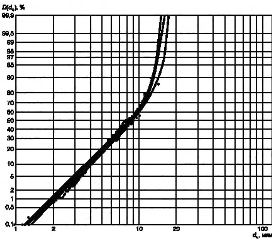
Рисунок 3 — Интегральные кривые распределения массы частиц по диаметрам в вероятностно-логарифмической сетке для пыли отобранный на промышленном предприятии
