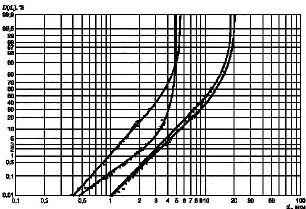
Рисунок 4 — Интегральные кривые распределения массы по диаметрам частиц  $D(d_4)$  в вероятностно-логарифмической координатной сетке для пыли
