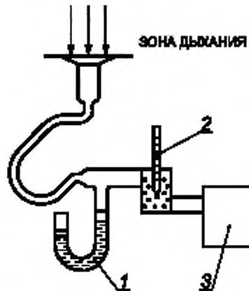
1 — манометр; 2 — термометр; 3 — аспиратор
