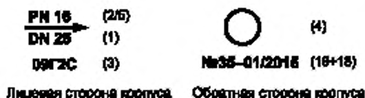
Рисунок Г.4 — Пример расположения маркировки обязательными знаками на корпусе обратного клапана
