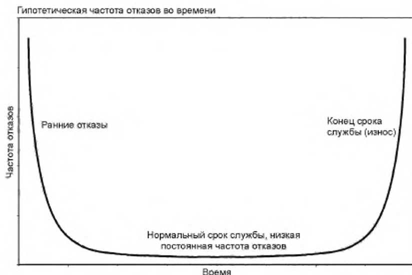
Рисунок В.1 — Модель U-образной кривой частот отказов электронных элементов
