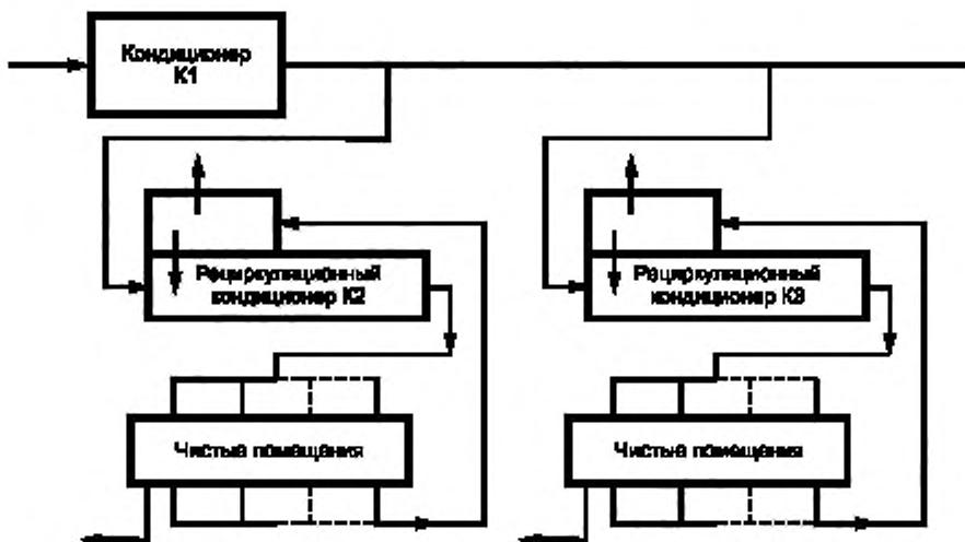
Рисунок А.4 — Двухуровневая система вентиляции и кондиционирования
